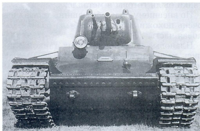
Первый образец танка КВ был вооружен двумя пушками (калибра 76 мм и 45 мм) – это было наследием многобашенных машин. Но от 45-мм пушки вскоре отказались
