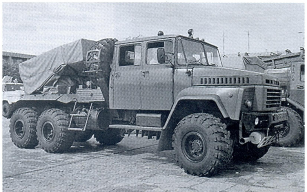
Украинский "Град" на базе автомобиля КрАЗ с двойной кабиной для размещения всего боевого расчета
