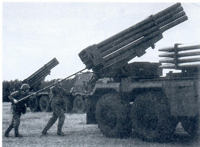
Заряжание установки RM-70 в армии ГДР. Виден запасной комплект ракет для быстрого перезаряжания
