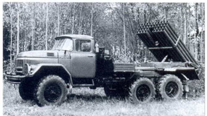
Пусковая установка "Град-1" с 36 трубами на шасси грузовика ЗиЛ-131
